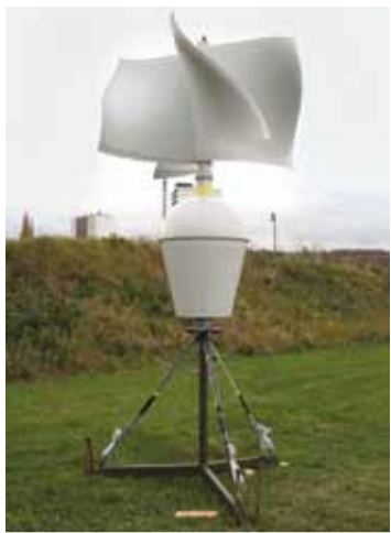
Mobile Windkraftwerke sollen Dieselaggregate im Feldlager ersetzen.
